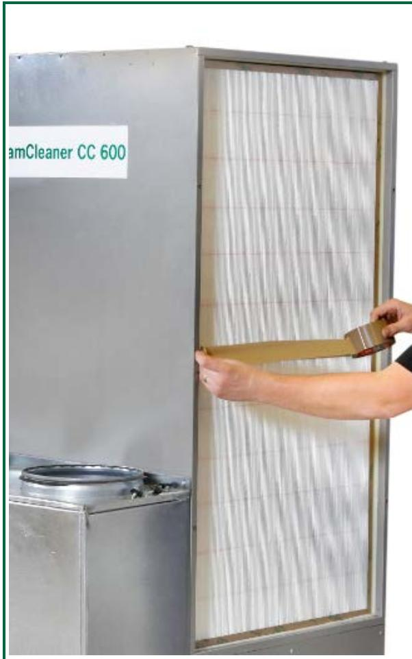
14. Spalt zwischen den Filtern möglichst Luftdicht mit Klebeband verschließen.
