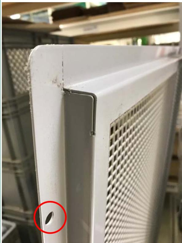
15. Gitter auf die 4 Metall-Pins setzen.
